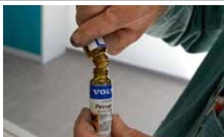
Mix the Butyl Primer and shake properly.
